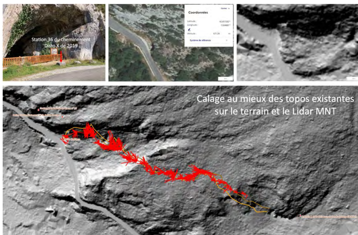
Petite Caugno : localisation d'un point de référence et plans sur le MNT du Lidar HD IGN. En attente des coordonnées du géomètre.
